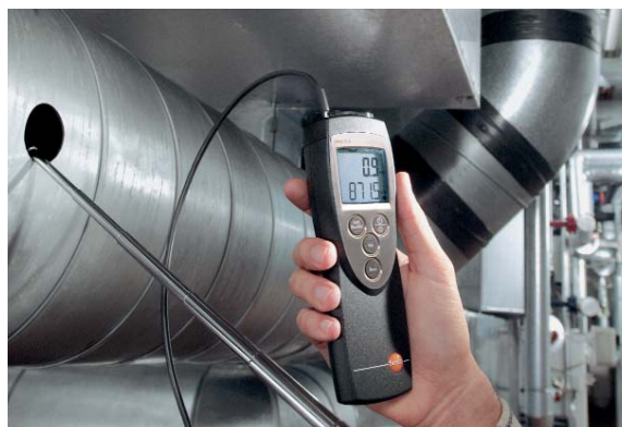
testo 425, ex. para controlar o caudal do ar de saída
